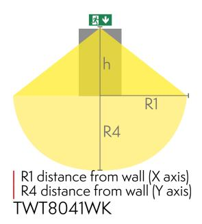
Mounting height (m) Below the light lux R4 (m) R4 (m) R1 (m) R1 (m) 1 lux 1 lux 0,5 lux 0,5 lux 2 1,1 0,5 1 1,5 0,7 2 2,5 1,5
